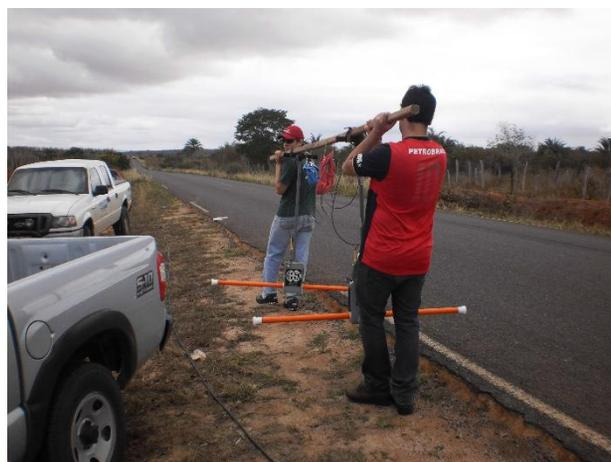
Figura 4 – Antena MLF de 80 MHz, montada e pronta para o início do levantamento dos perfis na BA-046.
