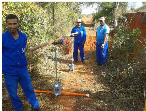
Figura 6 – Aquisição de dados de GPR utilizando antena MLF de 80 MHz próximo à cratera formada na margem da rodovia BR-122.
